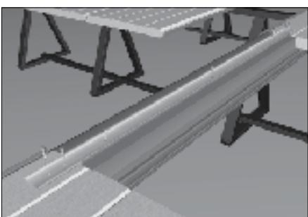
Переверните панель с установленным на нее верхним усилителем. Установите в паз верхнего ригеля усилитель карниза, расположите симметрично относительно центра проема калитки и закрепите его с помощью саморезов по отверстиям, сделанным на производстве.
