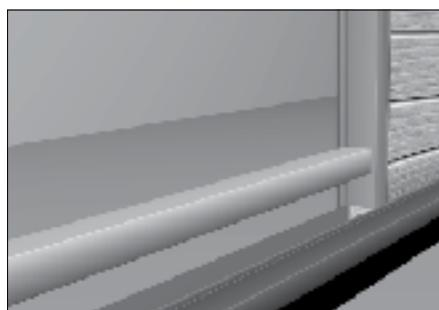
Установите полотно ворот на стапель для установки калитки. На стапель устанавливаются те панели, в которых вырезан проем калитки. Щит ворот выравнивается по торцевым крышкам и поджимается верхним прижимом.
