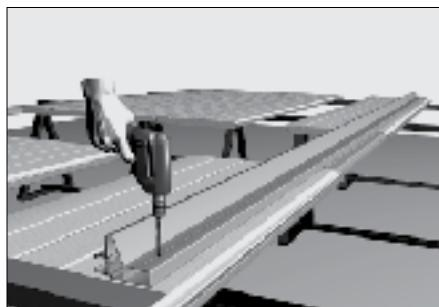
Просверлите отверстия Ø13,2 мм в верхней стенке алюминиевого профиля усилителя верхнего с шагом, указанным в карте цех. Закрепите профиль сквозь эти отверстия к панели с помощью саморезов.
