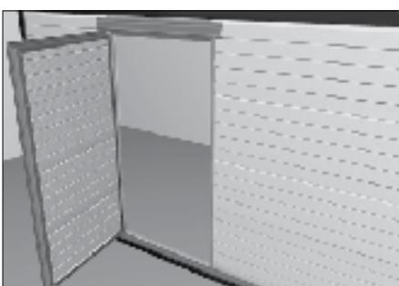
После сборки необходимо проверить работу калитки. Полотно калитки должно быть выставлено по уровню, без перекосов и зазоров, а в закрытом состоянии по периметру оно должно равномерно прилегать к щите ворот.
