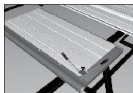
Установите алюминиевый профиль нижний несущий на нижнюю панель. Просверлите отверстия Ø4,2 мм с шагом не более 500 мм и закрепите профиль с помощью заклёпок.
