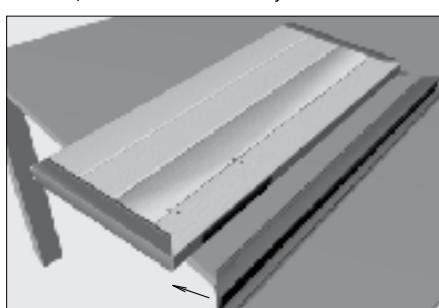
Вставьте закладной элемент для доводчика в панель таким образом, чтобы его отверстия совпали с отверстиями, просверленными в панели. Установите Ц-профиль обратно на панель.
