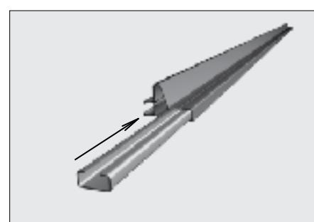
Возмите алюминиевый профиль усилитель верхний и вставьте в него стальной С-профиль. С обратной стороны профиля усилителя установите по пазам алюминиевый профиль ригель верхний. Где  $p$  — это B1-75 мм (либо B1-150 мм в случае двойных боковых опор), а  $m$  — это B2-75 мм (либо B2-150 мм в случае двойных боковых опор).
