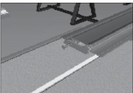
Задвиньте по пазам алюминиевый профиль карниза малый и установите справа и слева крышки профиля малого карниза. Закрепите крышки саморезами (допускается использовать заклёпки).
