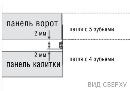
От длинномерной заготовки отрежьте заготовки петли необходимой длины (зависит от высоты панелей). Просверлите отверстия Ø4,2 мм в заготовленных петлях.
