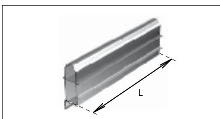
Отрежьте алюминиевый профиль ригель верхний длиной, равной ширине проема калитки. Отпишите справа и слева под углом 45° нижнее выступающее ребро профиля.
